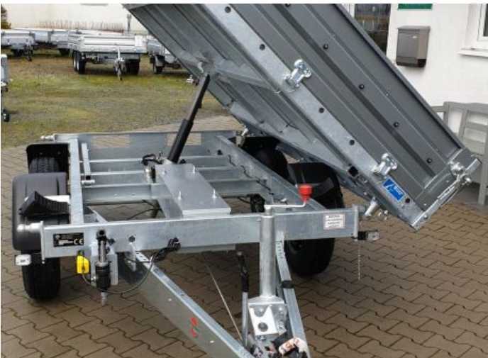
Stema Trius Dreiseitenkipper 3500kg 2mm Stahl Beplankung
