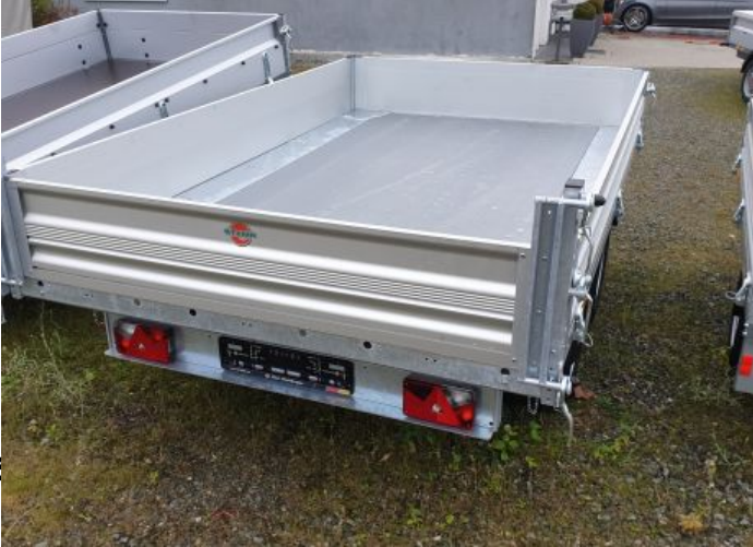
Stema Trius 3-Seitenkipper Alu Bordwand 3500kg
